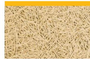
Placa acústica de 1 capa de lana de madera adhesivada con magnesita (ancho de fibra aprox. 1 mm)
