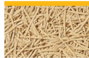
Placa acústica de 1 capa de lana de madera adhesivada con magnesita (ancho de fibra aprox. 3 mm)
