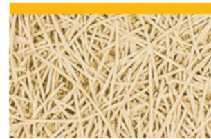
Placa acústica de 1 capa de lana de madera adhesivada con magnesita (ancho de fibra 2 mm)
